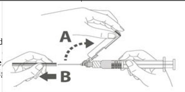
**Étape 4 :** Une fois l'injection terminée, verrouiller (activer) **avec une seule main** le bouclier de sécurité à l'aide de l'une des trois (3) techniques illustrées : activation à l'aide d'une surface, du pouce ou d'un doigt.
